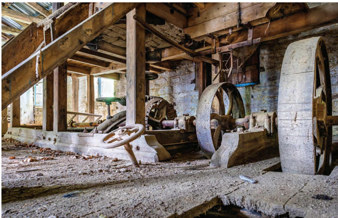
Τροχαλίες και ιμάντες του παλιού αλευρόμυλου
