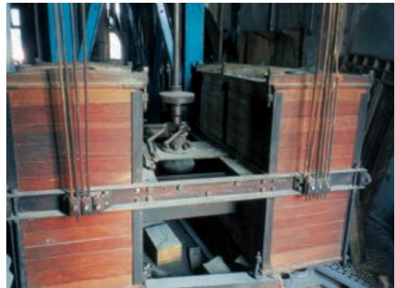
Όλα τα άλευρα από τα κόσκινα καταλήγουν στο τμήμα ομογενοποίησης (χαρμανιέρα). Εδώ φαίνεται το επάνω τμήμα της με τα συστήματα κάθετης και οριζόντιας μεταφοράς αλεύρων.
