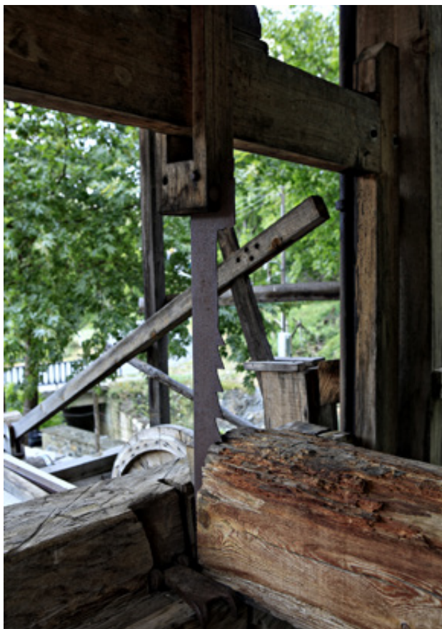
Ατσάλινο πριόνι με μεγάλα δόντια και χοντρός κορμός στο αναστηλωμένο παραδοσιακό υδροπρίονο στα Άρματα. Η Κινητήρια δύναμη το νερό, κυλούσε από τις πλαγιές του Σμόλικα δωρεάν. Χάρis σ' αυτό λειτουργούσε το παραδοσιακό υδροπρίονο, που εξυπηρετούσε τις ανάγκες κατεργασίας ξύλου όλης της ευρύτερης περιοχής
