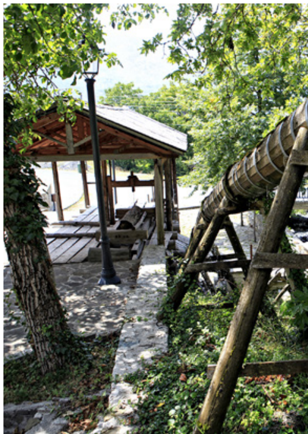
Από το αυλάκι διοχετεύετο το νερό στην καρούτα και με την ορμή που αποκτούσε έθετε σε λειτουργία το πρίονι
